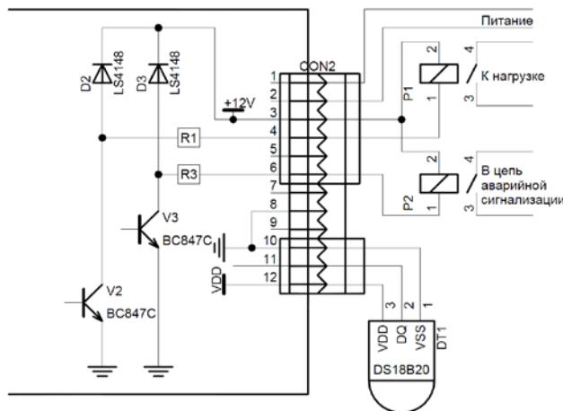
Внимание!!! Для питания можно использовать источник постоянного стабилизированного напряжения 12 вольт или переменного 8 вольт. Токовая нагрузка выходных транзисторных ключей не должна превышать 50 мА. Подробное описание смотрите на компакт диске прилагаемого к изделию. Для вопросов используйте форумы <http://forum.e-voron.dp.ua/>.
